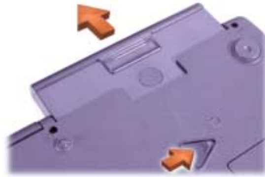
Figura 6-8. Remover a bateria do respectivo compartimento
