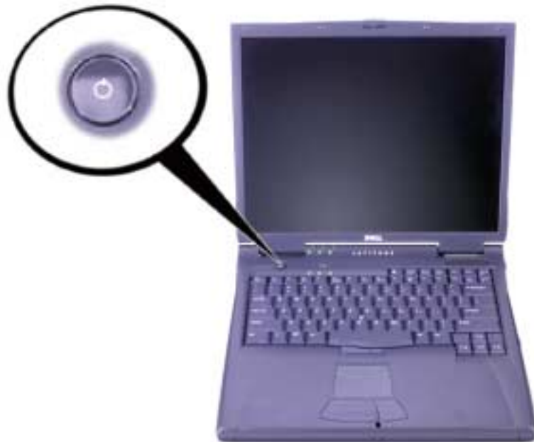
Figura 7-3. Encendido del ordenador
