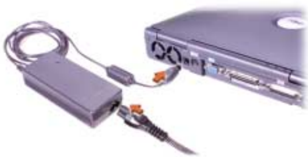
Figura 7-2. Conexión del adaptador de CA
