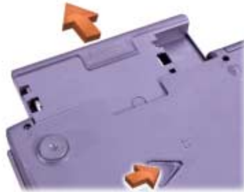
Figure 3-8. Retrait d'une batterie de la baie de batterie
